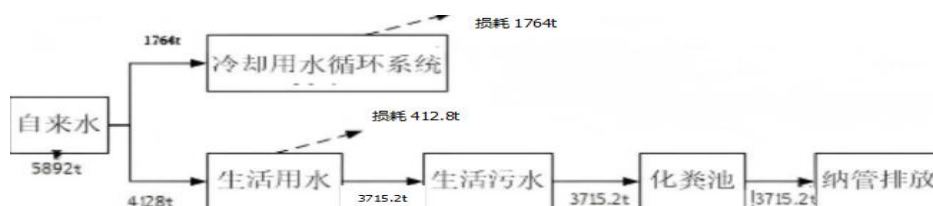
图 2.5.1 项目水平衡图
